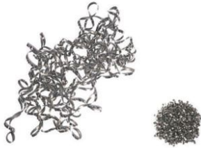
Cavacos gerados por usinagem convencional Cavacos com LFV
