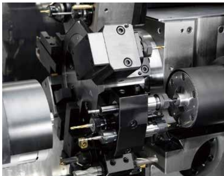
Usinagem traseira utilizando as ferramentas instaladas em um suporte de luvas triplo
