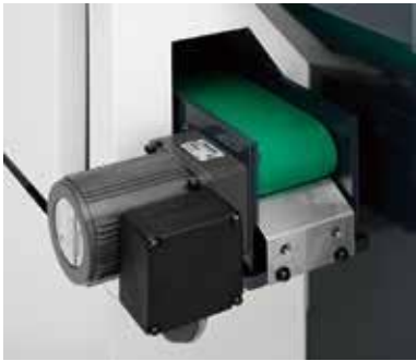
Transportador de Peças Estes aparelhos opcionais são indispensáveis para usinagem com barras.
