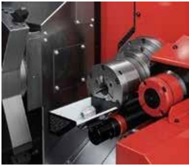
Aparador de peças Estes aparelhos opcionais são indispensáveis para usinagem com barras.
