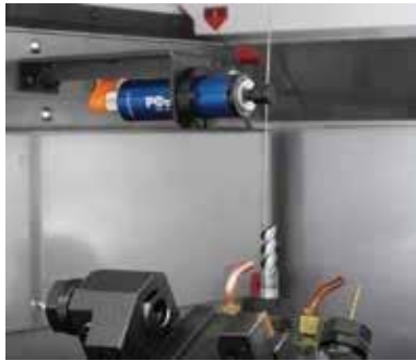
Detector de quebra de broca A quebra da broca é detectada pelo cilindro de torque. A máquina é parada quando a quebra é detectada, assim um segundo acidente pode ser evitado.
