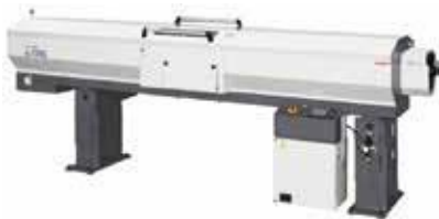
Alimentador de barras Unidade indispensável para operações automatizadas prolongadas com barras.
