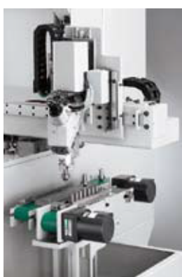
Carregador tipo gantry com percurso de alta velocidade de 154 m/min. no eixo X.
