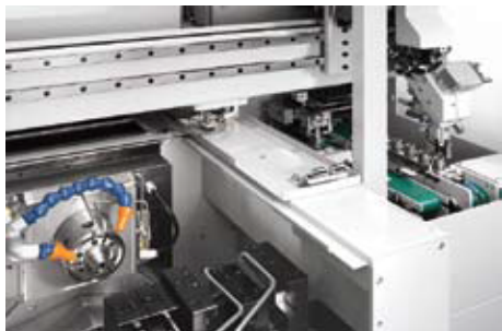
Carregador tipo gantry com percurso de alta velocidade de 154 m/min. no eixo X.
